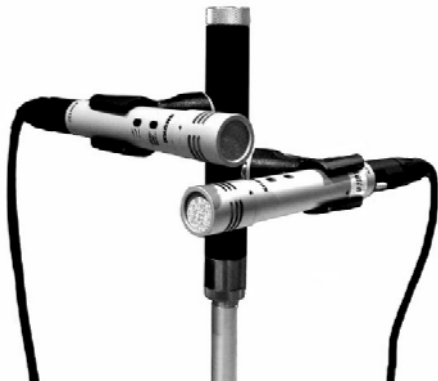
Рис.1. Схема расположения измерительных микрофонов по схеме X-Y
