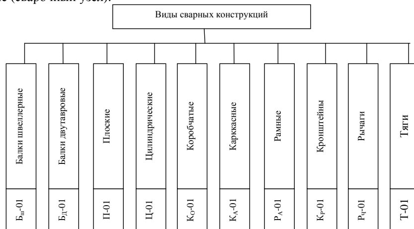
Рис. 1. Фрагмент графа декомпозиции сварных конструкций
