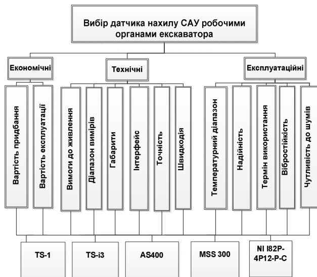
Рис. 1. Структурна модель вибору датчика нахилу системи автоматичного управління робочими органами екскаватора
