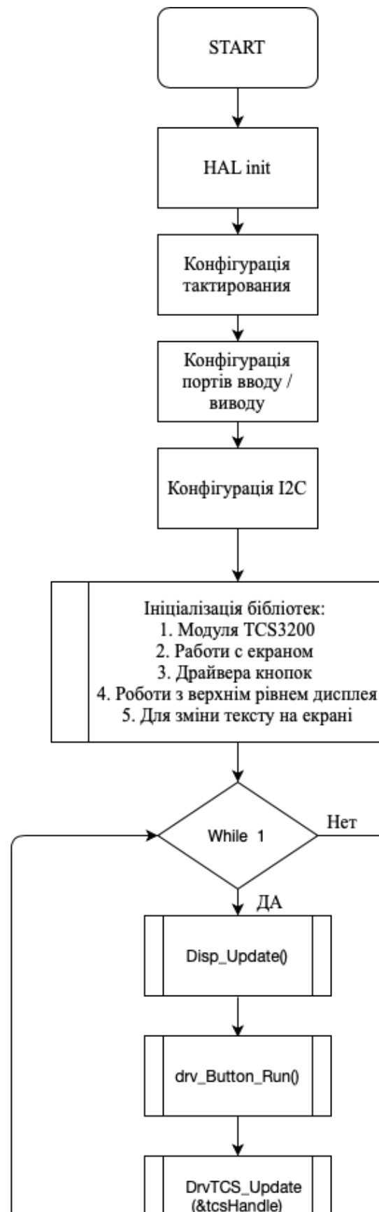
Рис. 3. Загальний алгоритм роботи програмного забезпечення стенду
