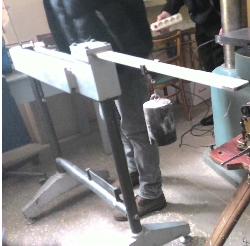
Рис. 2. Об'єкт дослідження механічних коливань – сталеві балка, що закріплена з одного кінця
