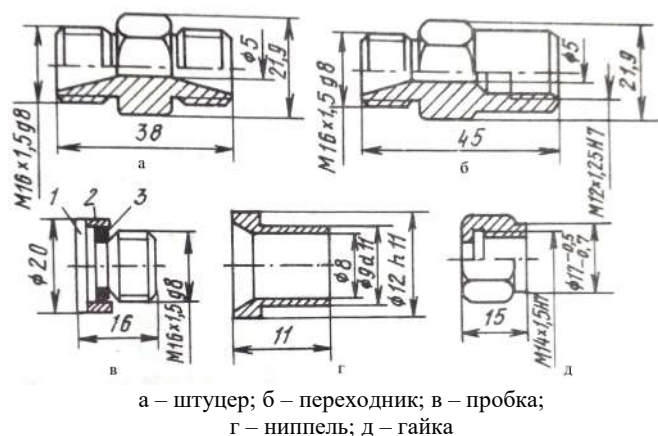
Рис. 13. Арматура для удлинения соединительных рукавов
